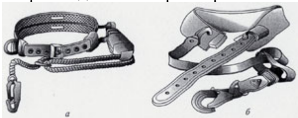
Рис.4. Предохранительные пояса: а — строительный; б — монтерский
